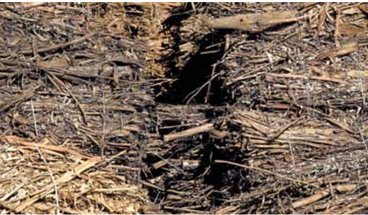
> Detalle de biomasa en fardos, que junto a cortezas, aserrín, desechos de madera y rollizos combustibles, alimentan la nueva caldera.
