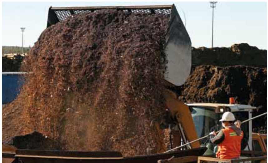
> Carguío de aserrín y virutas para proceder a la mezcla con los restantes tipos de biomasa.
